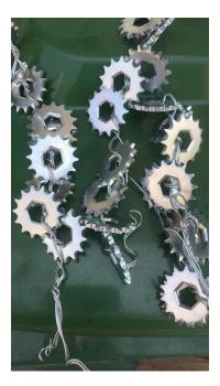
一般来说,有机浸渗剂是一种高分子材料,市场中\*\*为常见的是热固型浸渗液,主要成分是甲基丙烯酸酯类物。一般密度在1.03-1.07g/cm³之间,粘度5-10mpa.s□不含水。通过催化剂、温度等媒介发生交联化学反应,固化机理为化学变化,不可逆。如果液态下介质的纯度\*\*\*好,一般液态到固态接近等体积变化过程,所以堵漏合格率高,一般微孔零部件只要工艺满足要求、硬件设施达标,介质性能优异,一次浸渗合格率能达到98%左右,甚至更高。
